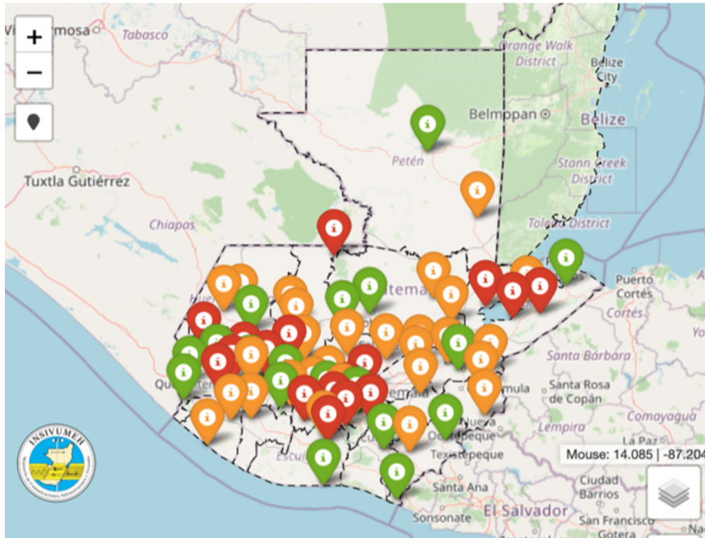
Imagen No. 4. Mapa de estaciones meteorológicas de la red convencional del INSIVUMEH. Reportan diariamente al menos variables de precipitación, nubosidad y velocidad y dirección del viento.
